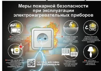
Наиболее распространенные причины, по которым может произойти короткое замыкание в квартире или доме - это перетиравание изоляции в местах, где провода перегибаются. Например, у входа в штепсельную вилку, патрон, настольную лампу, утюг и т.п., а также перекручивание проводов, сгибание проводов под острым углом, повреждение изоляции проводов при побелке, закорачивание металлическими предметами штепсельных гнезд, внутренних частей электрических патронов.
